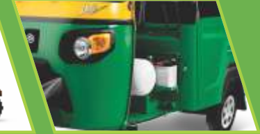
40 लीटर CNG सिलेंडर 20.6 लीटर LPG सिलेंडर
